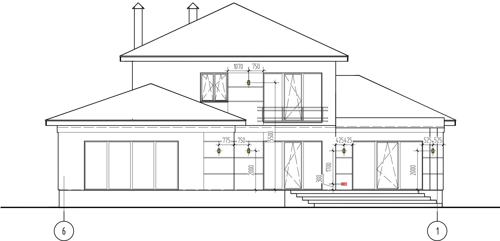
Схема установки электрических изделий на фасаде 6-1
